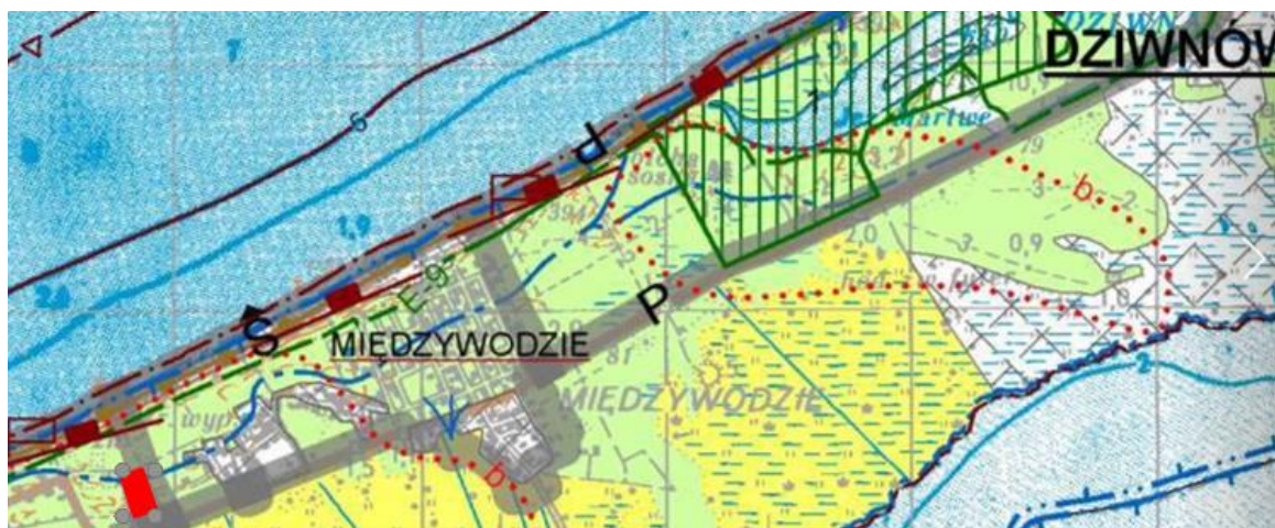
Rys. 13. Obręb Międzywodzie – obszar objęty opracowaniem na mapie geośrodowiskowej – czerwony poligon posiada korzystne warunki budowlane. Fragment Mapy Geośrodowiskowej Polski (źródło: dane PIG PIB, 2009 r.).
