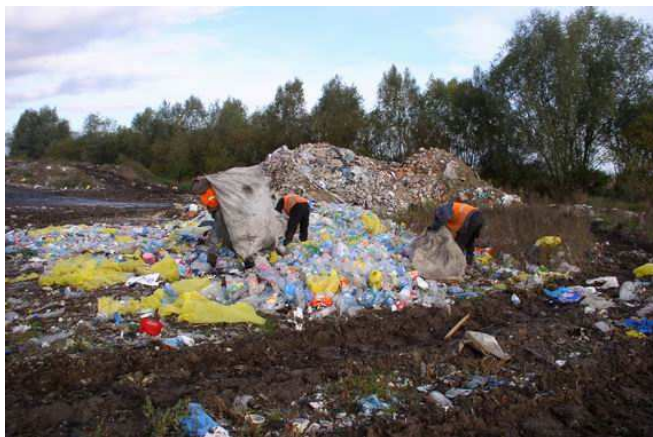
Zdjęcie 2 Ręczna segregacja odpadów typu PET na składowisku w Podańsku
