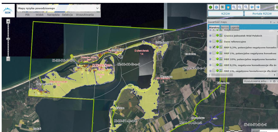
Rys. 8. Mapa zagrożenia powodziowego gminy Dziwnów raz na 500 lat (H0,2%) - niskie (źródło: ISOK, KZGW.gov.pl)
