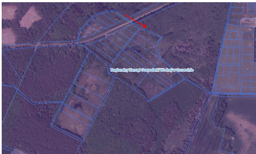
Rys. 3. Analizowany teren 37 US -A i B jest otoczony częściowo niedrożnym systemem melioracji, kanałami mającymi odprowadzać zbierające się wody powierzchniowe do rz. Świniec. Czerwona strzałka ukazuje kierunek grawitacyjnie spływających wód w rowach i kanałach. Dodatkowo prawdopodobnie zlikwidowane zostały rowy zbierające i odprowadzające do kanałów wody gruntowe z powierzchni dawnych łąk. (źródło: zdjęcie ortofotomapa geoserwis.gdos.gov.pl 2021 r.).
